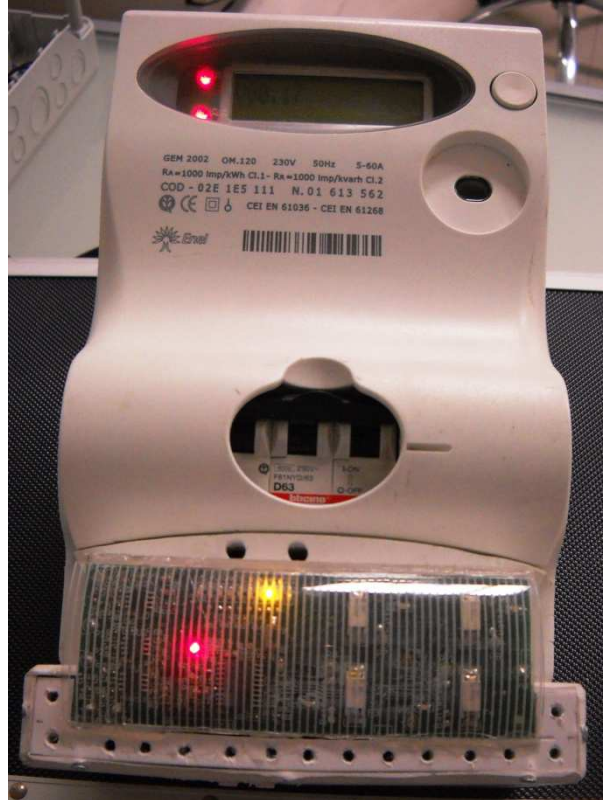
Esempio di installazione di Ekovar direttamente su contatore elettronico di energia elettrica.
