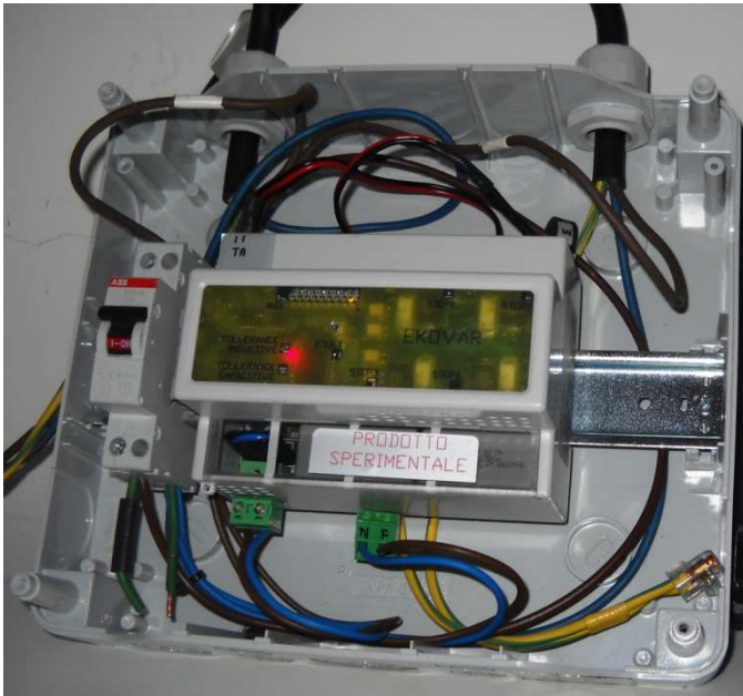
Exemplo de instalação em quadro modular Ekovar suporte trilho DIN
