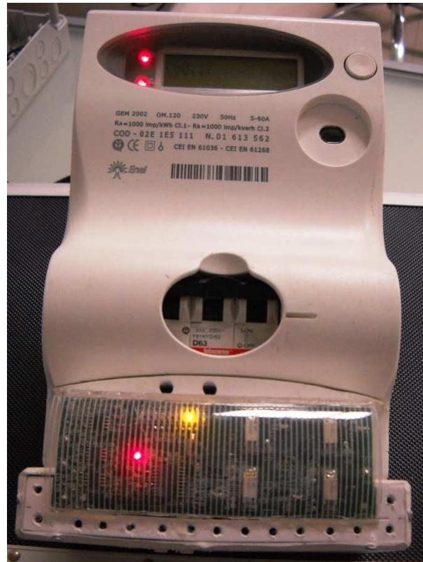
Exemplo de instalação de medidor eletrônico Ekovar diretamente no contador de eletricidade
